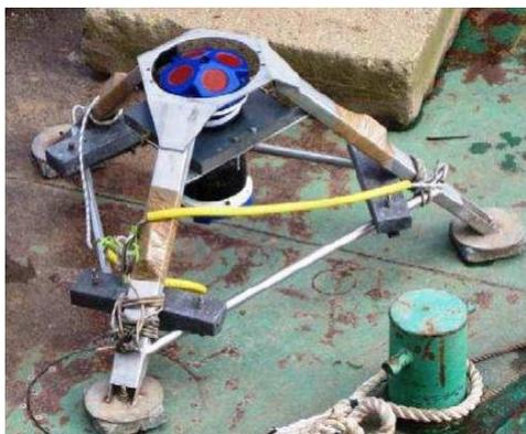
**FIGURE 12 :** ADCP prêt à être mouillé.
