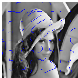
(c) Image après filtrage médian, gradient moyenné par un filtre gaussien.
